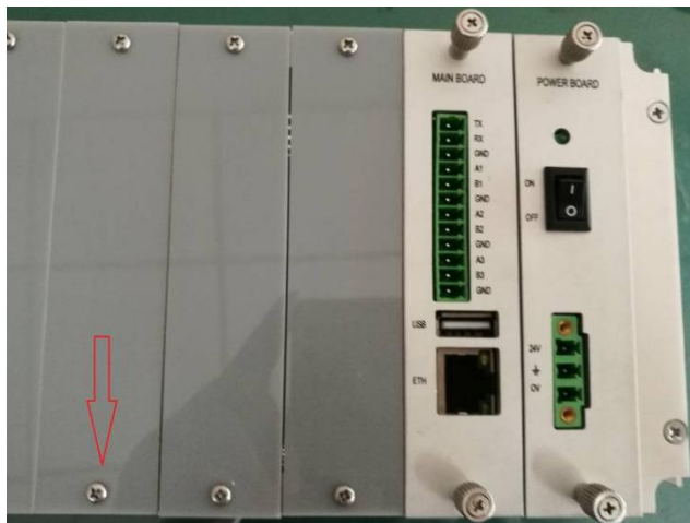
图 4.2 盲板固定螺钉示意图
