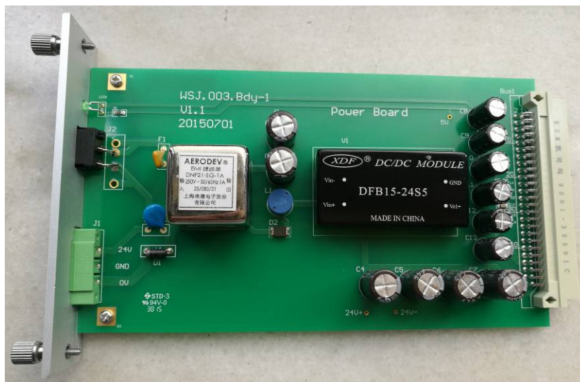
图 3.4 FCL-3 型流量计算机电源板结构图
